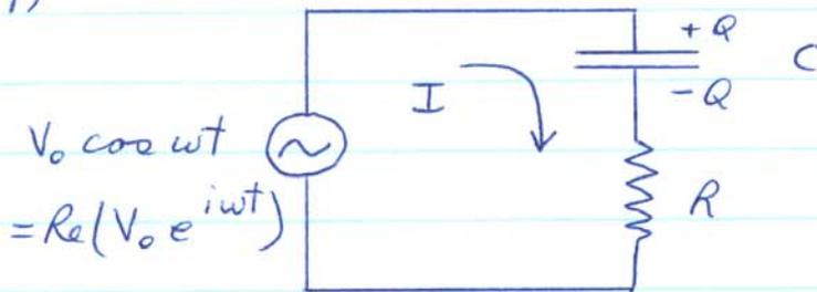
$$V_0 e^{i\omega t} = \frac{Q}{C} + IR$$
